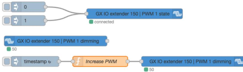
Der obere Teil dieses Ablaufs dient zum Ein- und Ausschalten des PWM-Anschlusses über den PWM-Zustandsparameter. Sobald der Anschluss eingeschaltet ist, wird der PWM-Wert verwendet, der mit dem PWM-Dimmparameter eingestellt ist. Der Eingangsknoten liest den aktuellen Wert des PWM-Anschlusses und speichert ihn im globalen Node-RED-Kontext.
