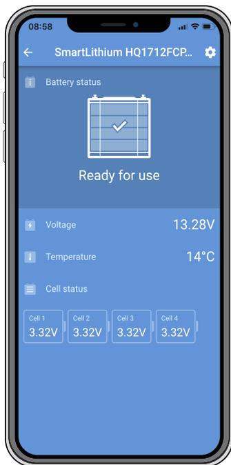
Die Batterie ist mit Bluetooth ausgestattet und nutzt dies zur Kommunikation mit der VictronConnect-App. Die VictronConnect-App wird zum Auslesen von Batterieinformationen, zum Vornehmen oder Ändern von Batterieeinstellungen, zum Empfangen von Alarmen und zum Aktualisieren der Firmware verwendet. VictronConnect enthält auch einen Demo-Modus.
