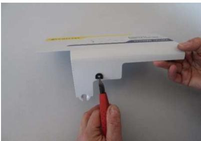
Einsetzen der Gummi-Kabeltülle
