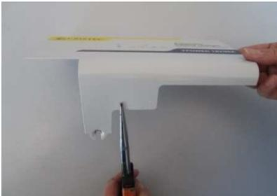
Abnahme der frontseitigen Abdeckung vom Gerät
