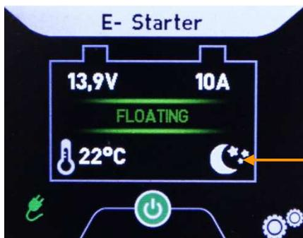
Der Night mode ermöglicht den geräuschlosen Betrieb, bei dem der interne Lüfter abgeschaltet wird.
