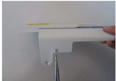
Ausbrechen der Metallzunge mit einer Flachzange
