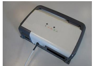
Einsetzen der Abdeckung und der Leitung.
