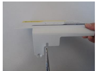
Ausbrechen der Metallzunge mit einer Flachzange
