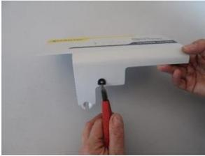
Einsetzen der Gummi-Kabeltülle
