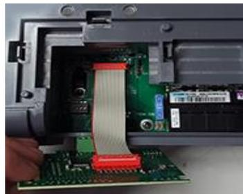
Die Interface Platine wird in durch drei Plastikklammern des Gehäuses festgehalten.
