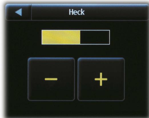
Wird der Button lange gedrückt so erscheint ein neuer Bildschirm auf dem die Helligkeit der Leuchte eingestellt werden kann, sofern dimmbare LED-Leuchten mit entsprechendem Steuereingang angeschlossen wurden.
