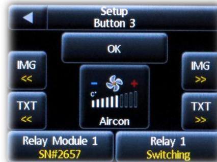
Nach Aufruf der Verbraucherseite erscheinen die Buttons entsprechend der Programmierung. Durch Drücken des Bildschirmbuttons wird der Verbraucher Ein bzw. AUS geschaltet. Der eingeschaltete Verbraucher wird durch einen grünen Haken gekennzeichnet.
