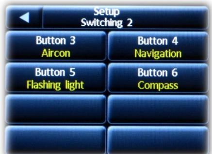
werden und ob ein Schaltbefehl für E-T-A PowerPlex, bzw. Relais auf welchem Relaismodul gesendet wird (Relaismodulnummer und Relais 1-4). Die Nummern der Tasten der 4 Seiten sind wie folgt fortlaufend durchnummeriert.
