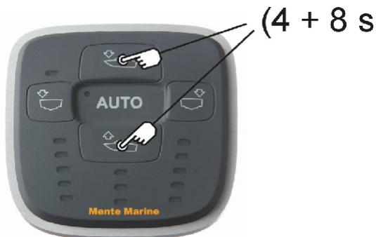
Die Anzeige AUTO blinkt und zeigt an, dass eine Kalibrierung notwendig ist. Drücken Sie die oberste und unterste Taste gleichzeitig für etwa 4 Sekunden, um eine Kalibrierung zu starten. Halten Sie die Tasten für noch 8 Sekunden gedrückt, während das ACS kalibriert wird.
