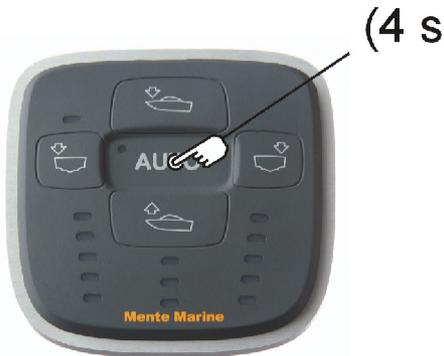
Fahren Sie das Boot mit normaler Gleitgeschwindigkeit. Trimmen Sie das Boot manuell bis Sie den optimalen Trimmzustand eingestellt haben. Danach drücken und halten Sie die Auto-Taste für 4 Sekunden unten, bis die AUTO-Anzeige aufleuchtet.
