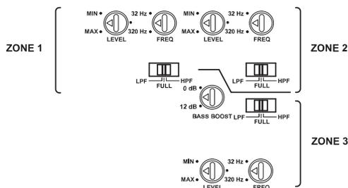
Für jede Zone gibt es einen Steuerungssatz, mit dem Sie den Ton für die mit dieser Zone verbundenen Lautsprecher konfigurieren.
