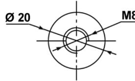
Anschluss: M8 Schraube oder M8 Poladapter
